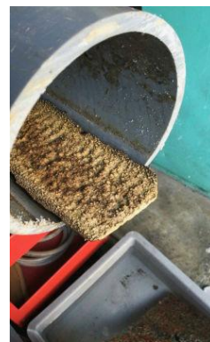
JR 東日本尿石剥離試験
