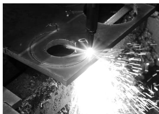
ガス切断の様子
